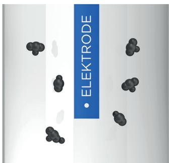
1. Feinstaubpartikel strömen mit der Abluft durch den Abgaskanal.
